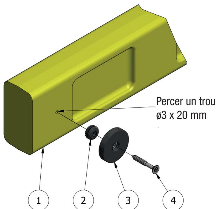
Serrez la vis de manière à ce qu'il reste environ 5 mm entre la rondelle magnétique et le portillon de sécurité. Le joint en caoutchouc permet de coincer la rondelle magnétique sans la bloquer complètement : il doit rester un peu de jeu. Elle peut ainsi entrer en contact direct avec le portillon de sécurité en métal.
