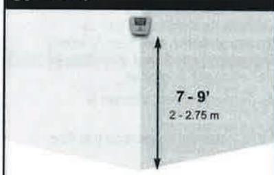
L'emplacement idéal de l'appareil se situe entre 2 et 2,75 mètres de hauteur. Installez-le à l'aide des languettes de montage situées sur le haut de l'appareil.
