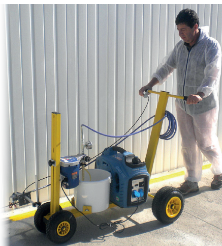
Flèche de guidage : Pistolet amovible pour traçage au pochoir
